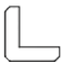
Profil d'angle sortant raboté AB non resséché : 60 x 60 mm selon longueur disponible
